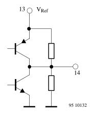
Figure 17. Pin 14 FM<sub>out</sub>
